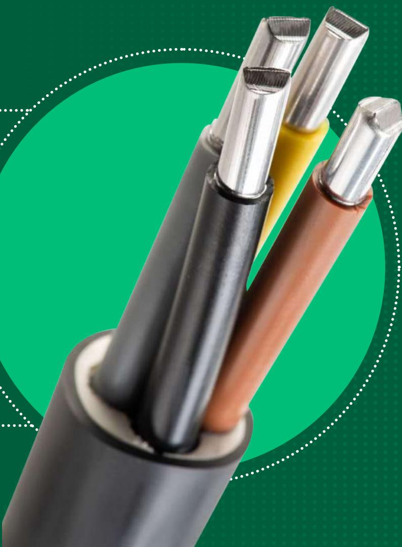
Кабели силовые гибкие с многопроволочными жилами из алюминиевого сплава, с изоляцией из поливинилхлоридного пластика, предназначенные для передачи и распределения электрической энергии в стационарных установках на номинальное переменное напряжение 0,66; 1 и 3 кВ, номинальной частотой 50 Гц.
